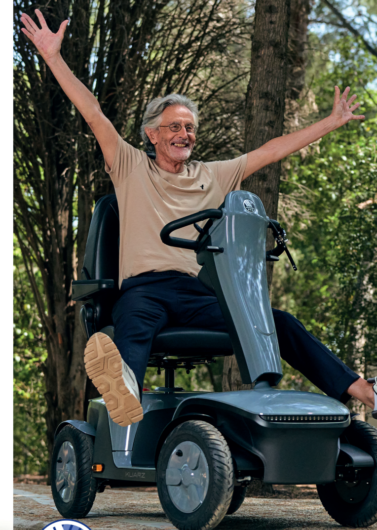
les amortisseurs sur les roues et la suspension au bas du siège procurent une sensation de conduite plus agréable.
